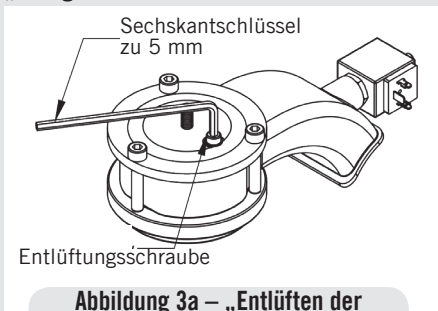
Abbildung 3a – „Entlüften der Brühgruppe AV“
